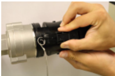
Рис. 18 Снятие защитной крышки
