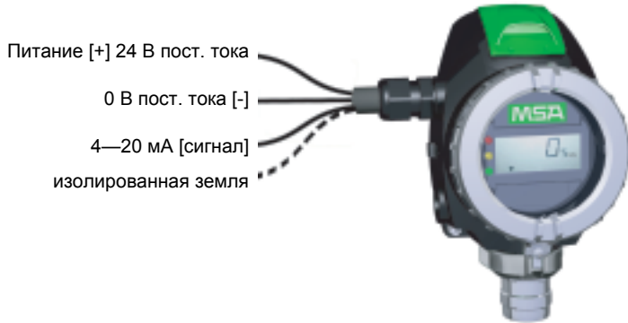
Рис. 5 3-проводное/4-проводное подключение - PrimaX P
